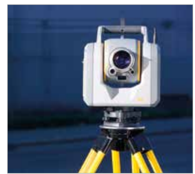
► Figura 9 Equipamento Trimble SX10, com câmera telescópica, usado na figura 10, para inspeção de obras de arte para registro de fissuras e da aparência externa do concreto
