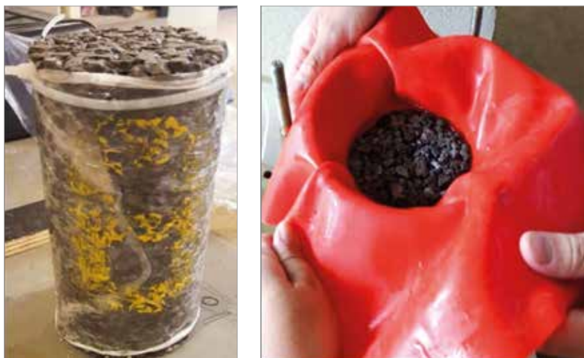
► Figura 6 Preparação do CP para ensaio de permeabilidade de carga constante
