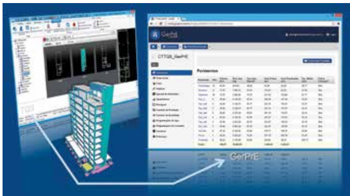
► Figura 3 Envio dos dados do projeto estrutural – formas e quantitativos de insumos – para o GerPrE
