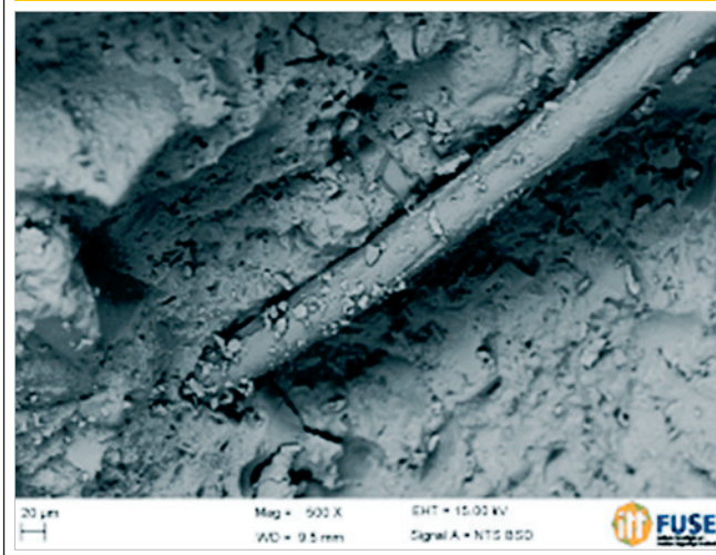
Figura 12 - Imagem de MEV da massa densa sem visualização dos cristais hidratados na interface entre a matriz e a fibra metálica
