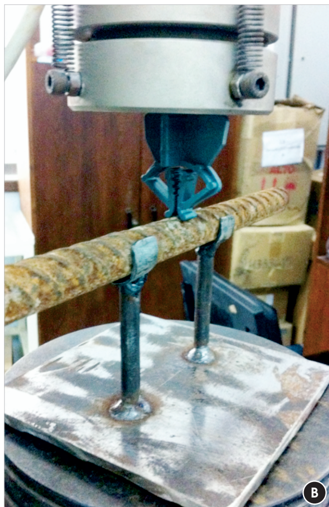
Figura 14 - Ensaio de aplicação do espaçador à barra de aço: a) em espaçadores circulares; b) em espaçadores cadeirinha
