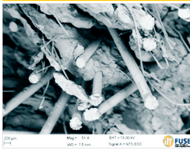
Figura 11 - Imagem de MEV da distribuição e geometria das fibras em um trecho da amostra
