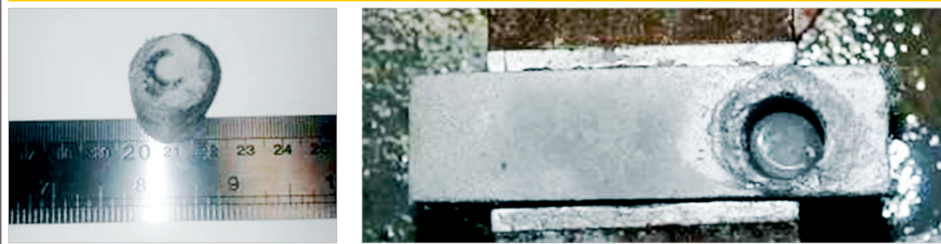
Figura 4 - Amostra para o ensaio de microtomografia 3D
