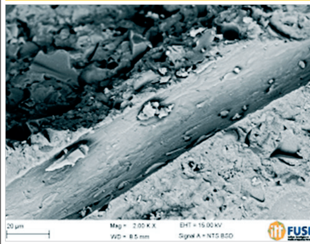
Figura 13 - Imagem de MEV sulco deixado pela fibra arrancada na fratura do corpo de prova
