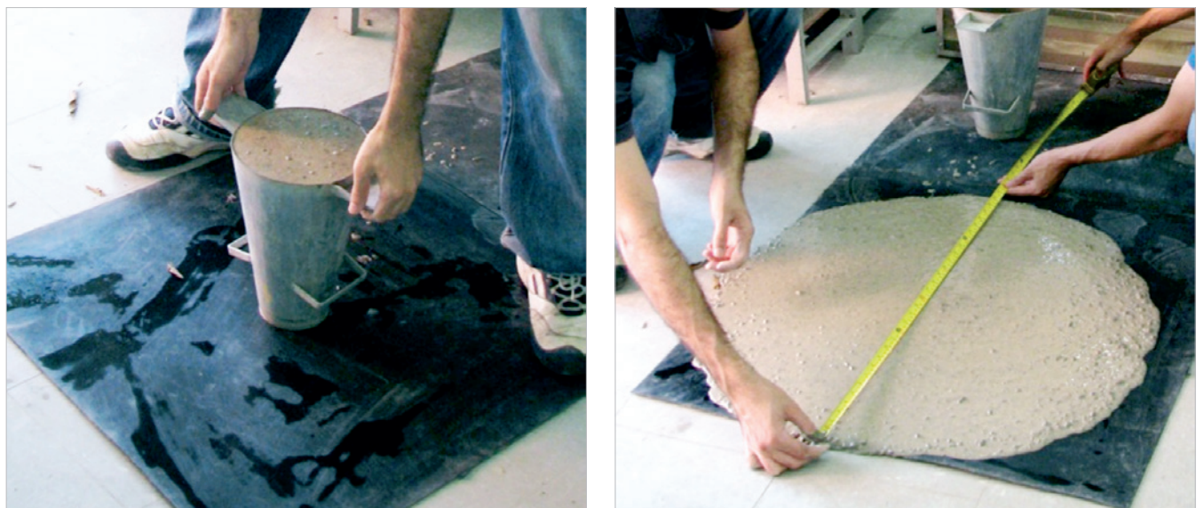
Figura 5 – Medição do diâmetro de espalhamento
