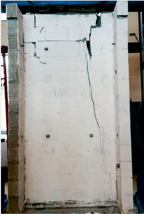
Figura 14 - Ruptura - Parede com flanges com apoio central 03
