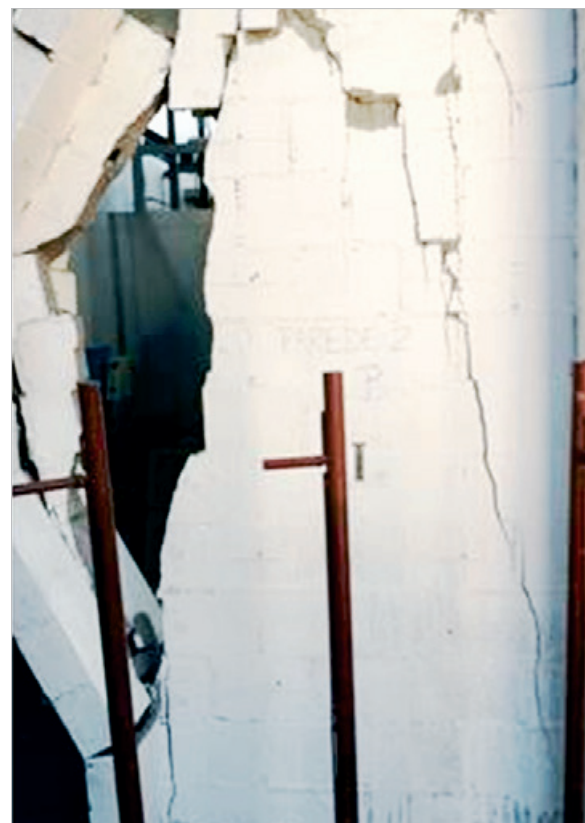
Figura 13 - Ruptura - Parede com flanges com apoio central 02
