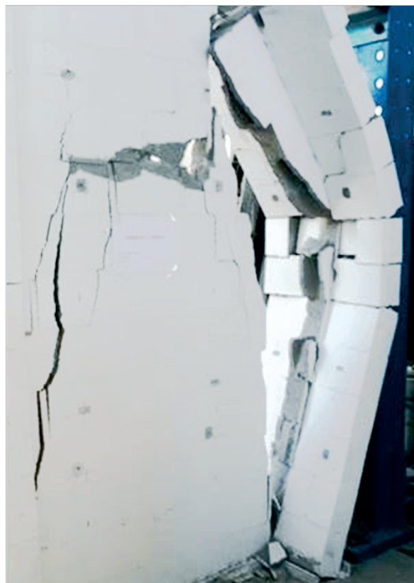
Figura 12 - Ruptura - Parede com flanges com apoio central 01
