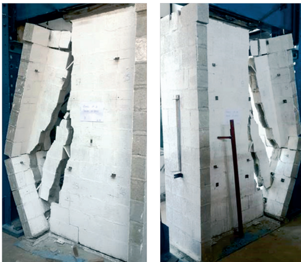
Figura 17 - Ruptura - Parede com flanges sem apoio central 06
