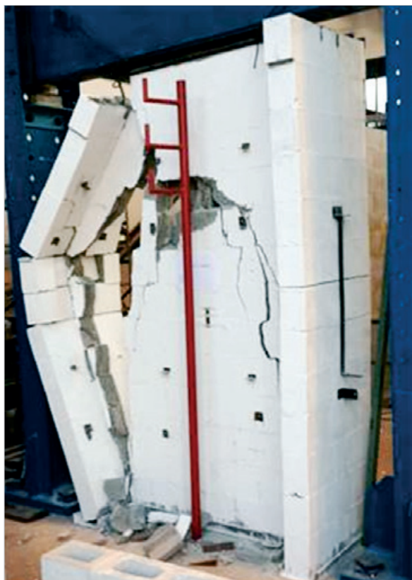
Figura 12 - Ruptura - Parede com flanges com apoio central 01
