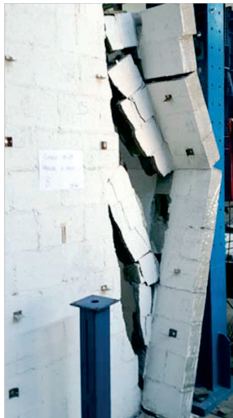
Figura 15 - Ruptura - Parede com flanges sem apoio central 04
