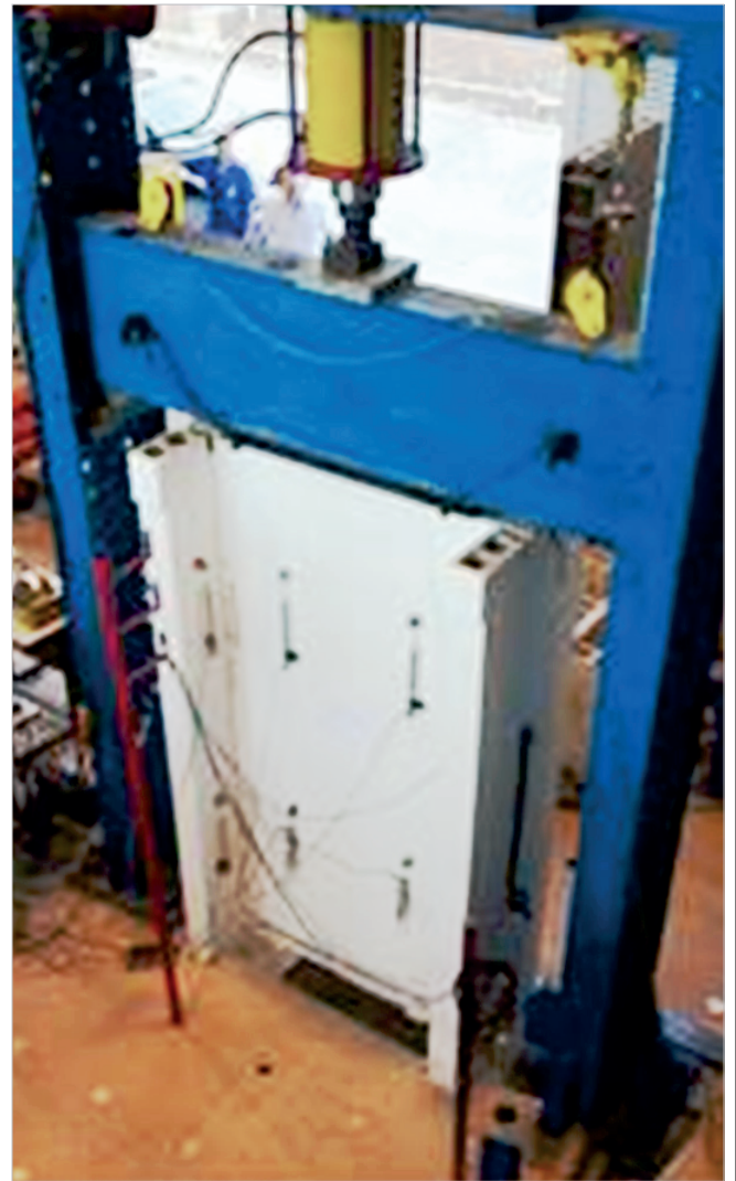
Figura 6 – Parede com flanges instrumentada e detalhe do pórtico de reação
