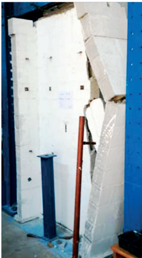
Figura 15 - Ruptura - Parede com flanges sem apoio central 04
