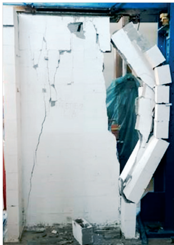
Figura 13 - Ruptura - Parede com flanges com apoio central 02
