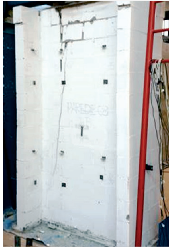
Figura 14 - Ruptura - Parede com flanges com apoio central 03
