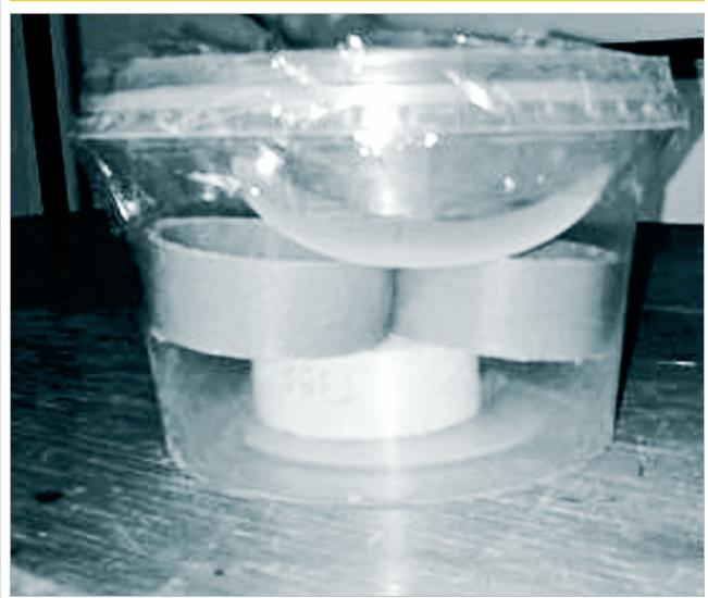
ção do papel-filtro por causa do contato com a mão do operador, motivo pelo qual o uso de luvas e pinças para o seu manuseio foi adotado. Devido à pequena massa dos papéis-filtros, uma balança com resolução de 0,001 g ou menor deve ser usada.
