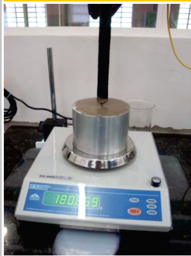
Figura 2 – Dispositivo de mensuração da perda de massa por evaporação
