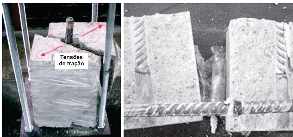
Figura 10 Ruptura típica por fendilhamento nos modelos CR e aspecto da ligação rompida
