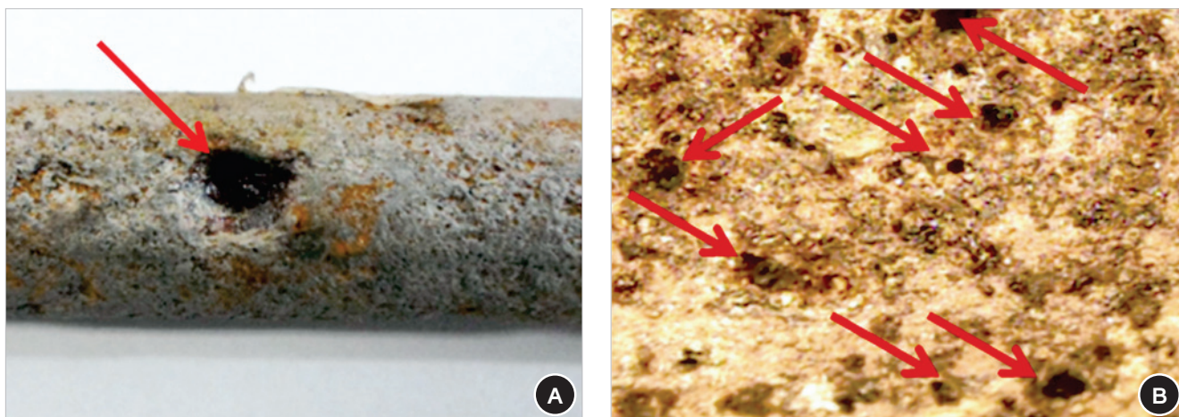
Figura 11 (a) Imagem de pite obtida por inspeção visual; (b) Micrografias mostrando a presença de pites em determinada região de um corpo de prova. Aumento de 10x
