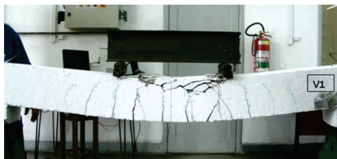
Figura 8 Aspecto da ruptura e da fissuração das Vigas V1 e V2
