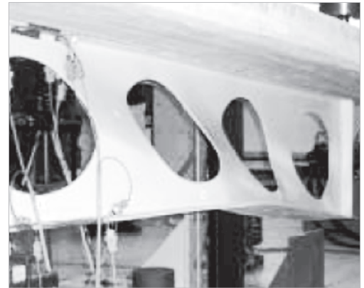
B Colapso por FLD
