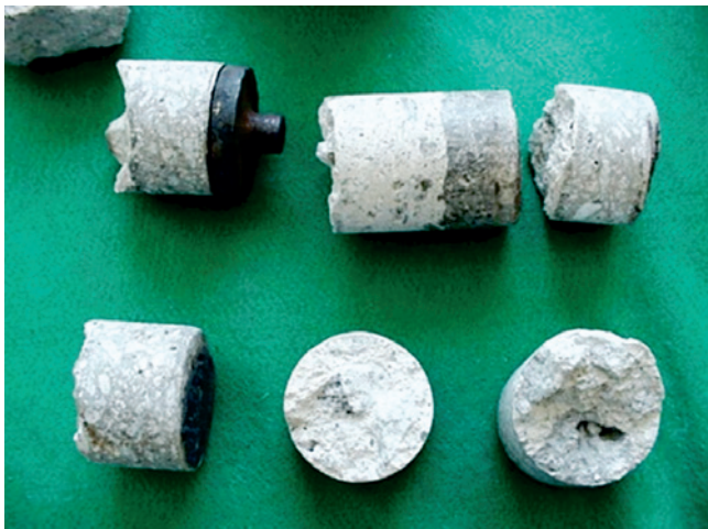
Figura 11 Fotografia dos testemunhos rompidos
