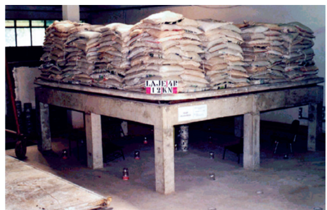
Figura 4 Fotografia da laje L4R com carregamento de 12,0 kN/m²
