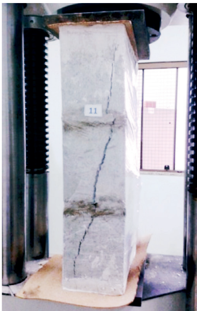
Figura 6 Ensaio de compressão axial de prisma assentado com três blocos
