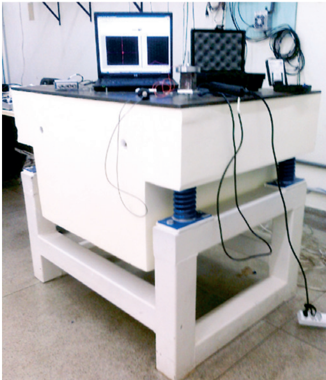
Figura 6 Mesa inercial com aparato experimental para realização da AME
