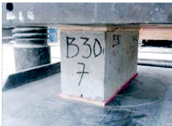
Figura 21 Ensaio dos blocos de concreto
