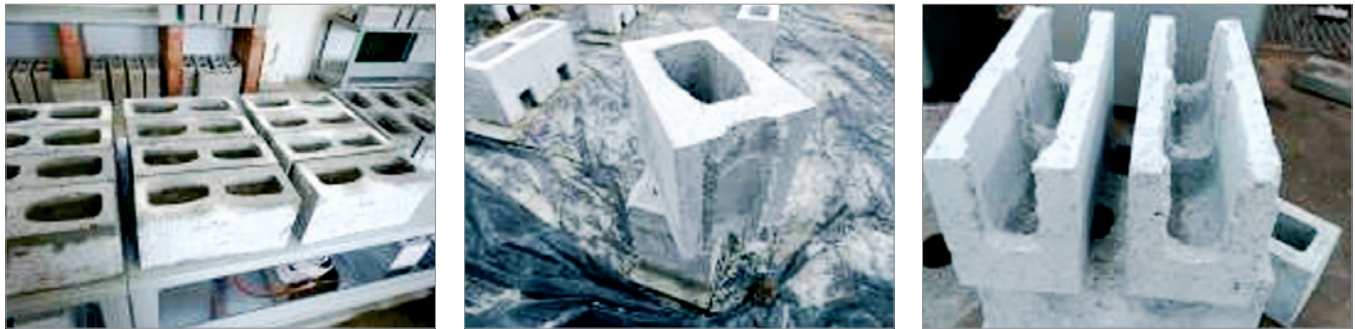
Figura 5 Ilustração dos blocos de concreto inteiros e cortados, e as canaletas utilizadas
