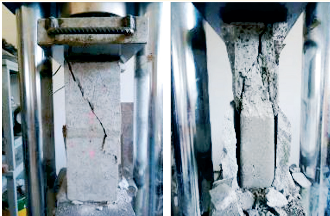
Figura 22 Ilustração dos ensaios prismas ocós e grauteados
