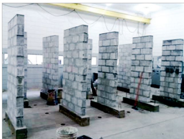
Figura 14 Ilustração das paredes construídas para os ensaios de compressão
