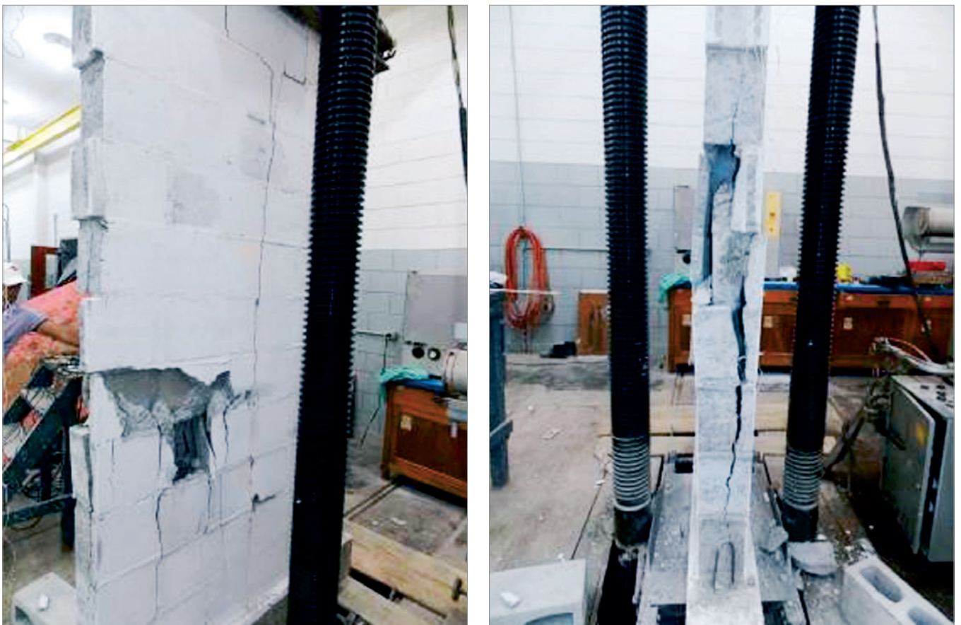
Figura 29 Ilustração da ruptura com fissuração vertical e esmagamento da alvenaria
