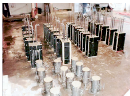
Moldagem das estacas
