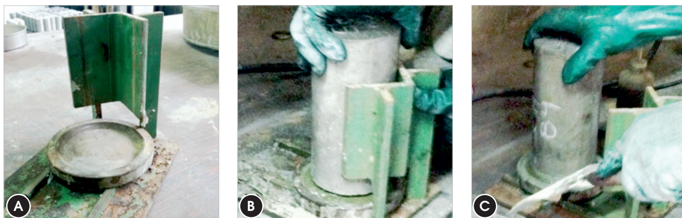
Figura 1 Aparelho para capeamento e execução do capeamento colado com enxofre
