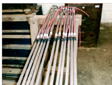
Instrumentação de armaduras
