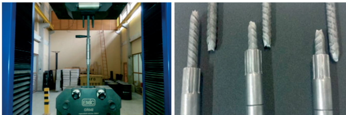
(a) Realização do ensaio de tração (b) Ruptura na barra de aço.
