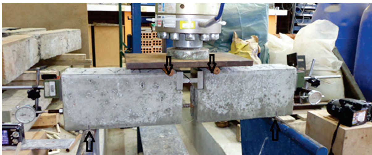
Figura 3 - Execução do ensaio da viga
