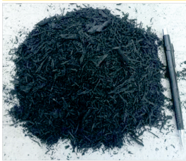
Figura 6 – Borracha triturada em tiras finas usadas como adição no concreto
