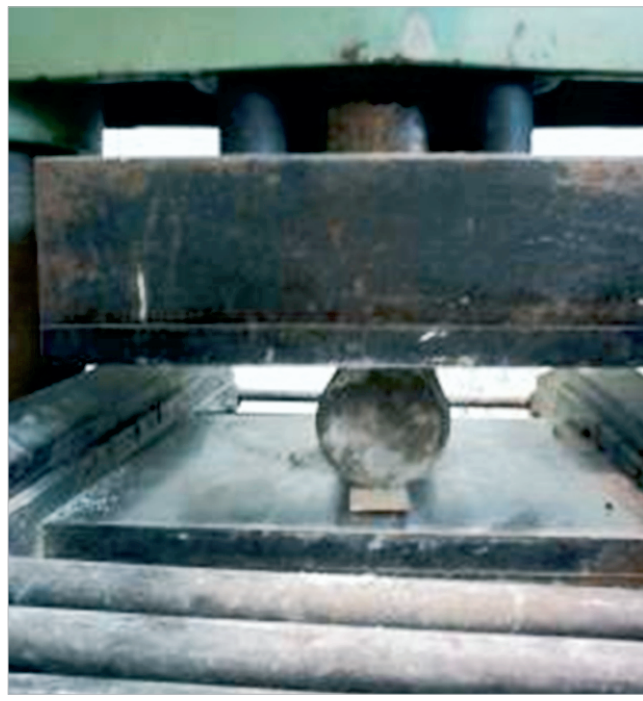
Figura 13 - Ensaio de compressão diametral
