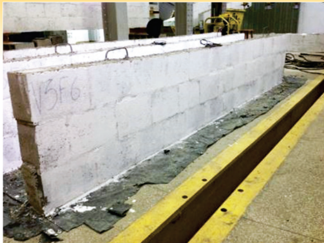
Figura 8 Viga de alvenaria estrutural após sua confecção
