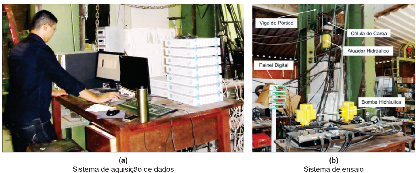
Figura 9 Sistema de aquisição dos dados e bombas hidráulicas para aplicação da carga
