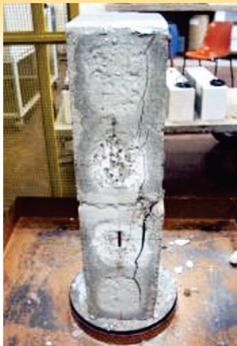
Figura 13 Prismas após o ensaio de compressão simples
