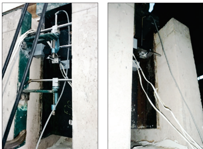
Figura 7 Posicionamento dos LVDTs horizontais e dos LVDTs verticais nos modelos experimentais
