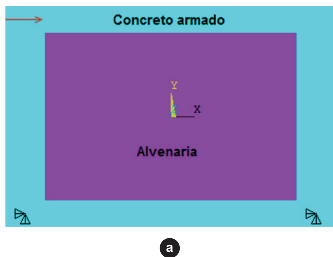
Figura 4 Modelo MEF de pórtico de concreto armado preenchido com alvenaria: a) condições de contorno; b) modelo discretizado
