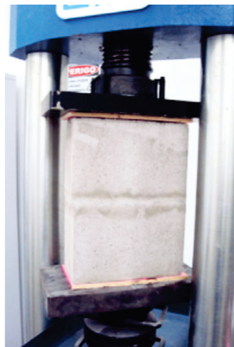
Figura 10 Esquema de ensaio utilizado para os prismas convencionais
