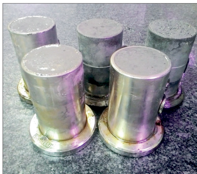
Figura 3 Corpos de prova para atividade pozolânica
