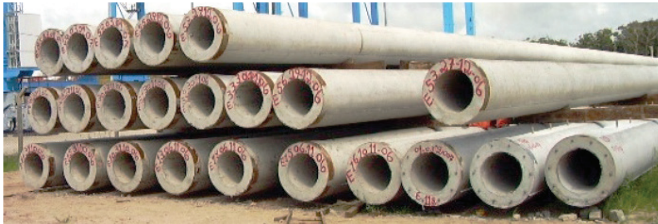
Figura 2 – Estacas protendidas pré-moldadas (fonte: Banco de imagens FURG)
