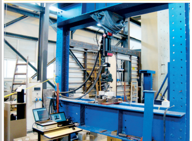
Figura 5 – Sistema de aplicação de carga – pórtico com atuador MTS 244.22
