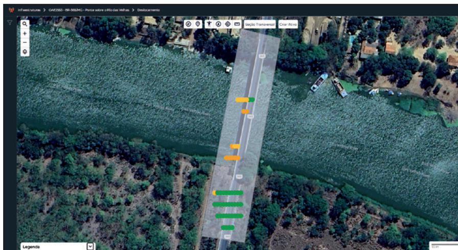
Pontos refletivos sobre o Rio das Velhas, na BR-365/MG, usados para aferir seu deslocamento pela tecnologia InSAR
