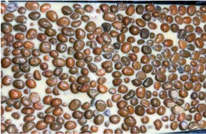
FIGURA 6 ARGILA EXPANDIDA NO PROCESSO DE IMPREGNAÇÃO FONTE: AUTORES (2024)
