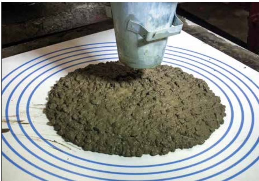
Teste de abatimento do concreto, no qual, além da fluidez, nota-se a coesão e homogeneidade da mistura
