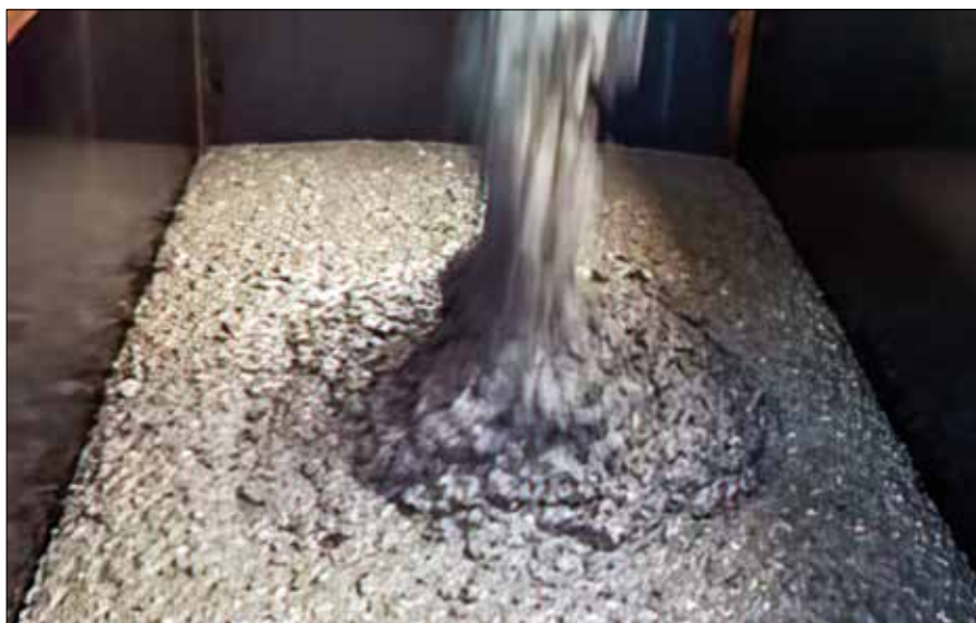
Concreto de ultra-alto desempenho usado na produção de bases de apoio de segmentos de ímãs do acelerador Sirius.
