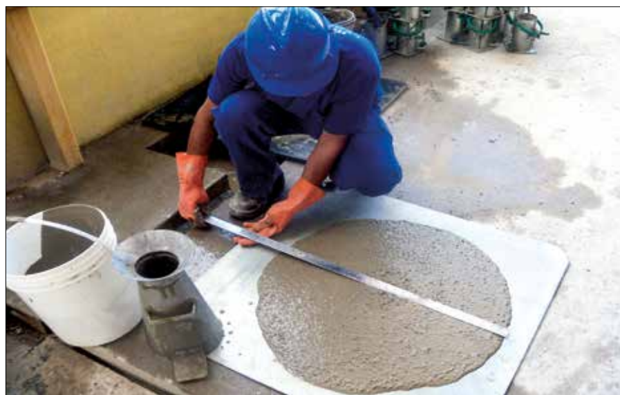
Ensaio de abatimento do tronco de cone, normatizado pela ABNT NBR 16889, para aferir trabalhabilidade do concreto.
