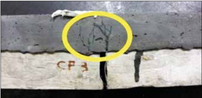
FIGURA 4 MICROFISSURAÇÃO OBSERVADA EM CORPO DE PROVA PRISMÁTICO DE ECC FONTE: FREITAS JÚNIOR; GARCEZ (2017)
