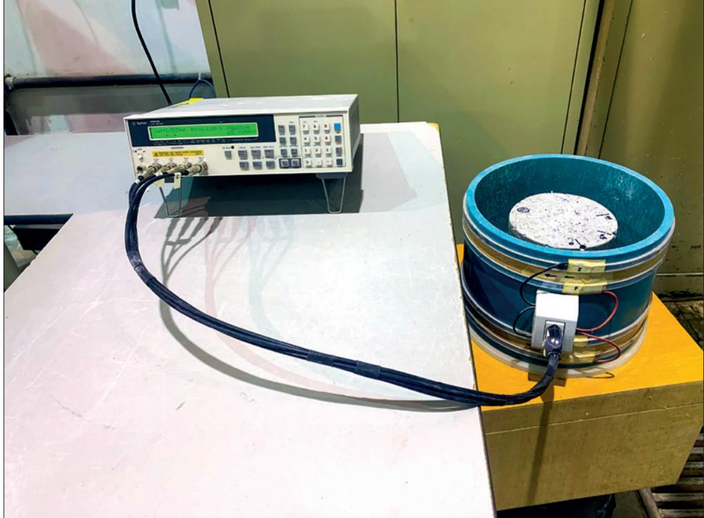
Ensaio indutivo em corpo de prova cilíndrico
