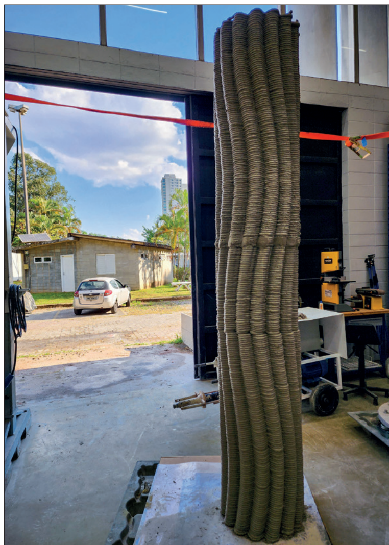
Coluna impressa com microconcreto desenvolvido sob coordenação do Prof. Rafael Pileggi
