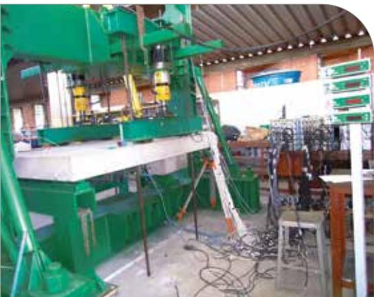
Laje posicionada para ensaio de punção
