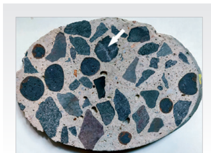
► Figura 7 Amostra de concreto com argila expandida e bactérias Fonte: Autores (2021)
