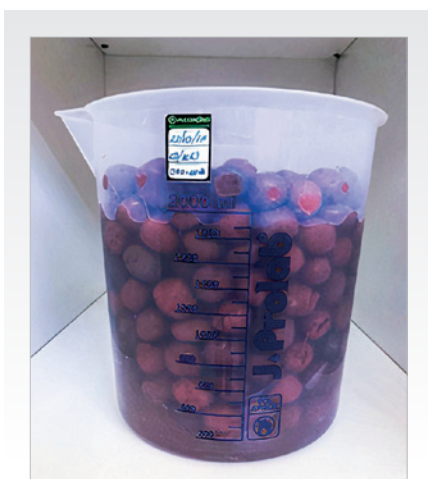
Figura 3 Processo de encapsulamento em argila expandida Fonte: Autores (2021)
