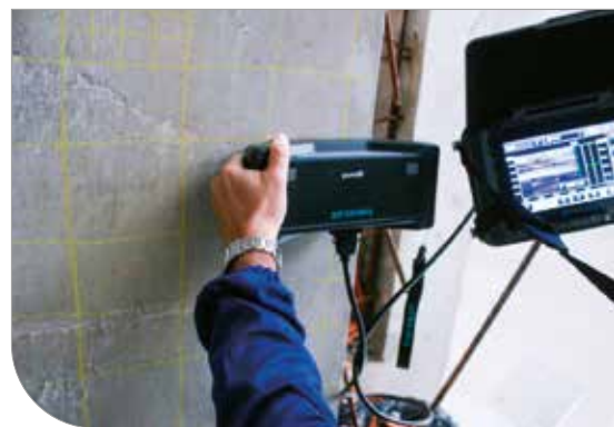
Avaliação de eco pulso ultrassônico (tomografia) na cabeça do Pilar PQ-8 da Arena Corinthians, para avaliar a existência problemas internos no concreto, bem como sua homogeneidade
