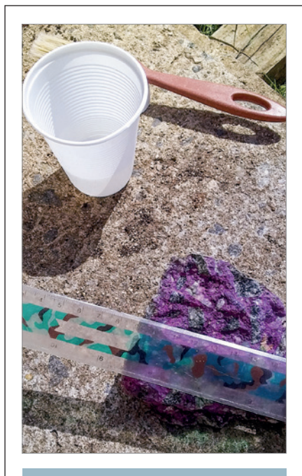
► Figura 2 Espessura de carbonatação do trecho exposto ao ar, sendo medida a espessura de 4 mm, não reagente à solução de fenolftaleína
