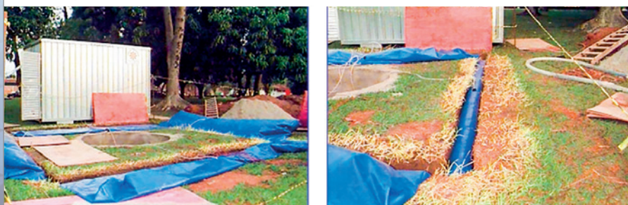
Poço construído para programa experimental no qual se avaliou a influência dos carregamentos no revestimento de concreto projetado com fibras
