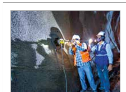
TENSÃO DE ADERÊNCIA CONCRETO PROJETADO X ROCHA
