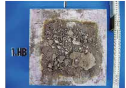
► Figura 5 Área de suporte da placa incandescente no teste preliminar ao usar uma argamassa polimérica para reparos estruturais (MC Bauchemie)
