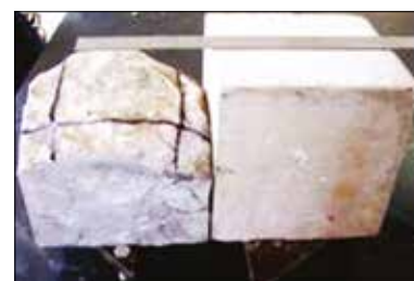
► Figura 2 Exemplo de perda de camada superficial do concreto por efeito de lascamento explosivo após realização de ensaio de exposição do concreto a chama [8]
