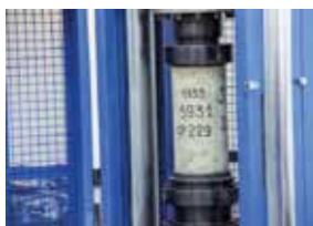
Levantamento de toda a documentação do Programa. Ruptura de alguns corpos de prova restantes, inclusive 2 da primeira amostra nº 3931 com 86 anos de idade.
