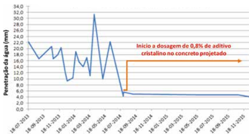
► Figura 14 Controle da permeabilidade das amostras extraídas em mm de penetração de água ao longo de 26 meses conforme a evolução da obra do túnel
