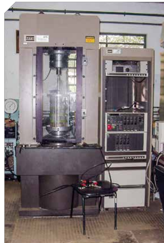
Prensa servocontrolada do laboratório de mecânica de rochas da Escola de Engenharia de São Carlos
