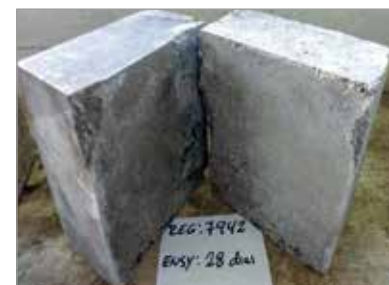
► Figuras 16 e 17 Amostras ensaiadas pelo método ASTM D6916
