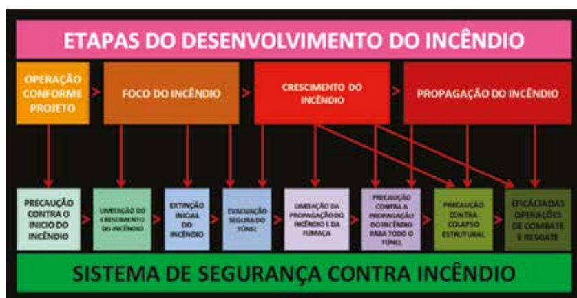
► Figura 7 Abordagem sistêmica da segurança contra incêndio
