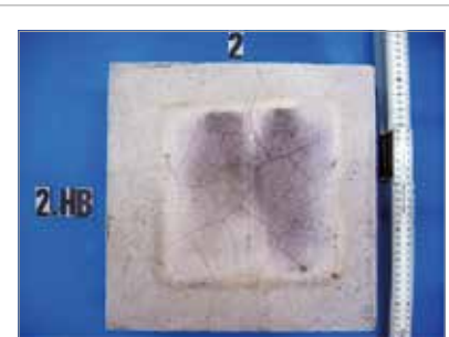
► Figura 6 Área de suporte da placa incandescente no teste preliminar usando um concreto geopolimérico (MC Bauchemie)
