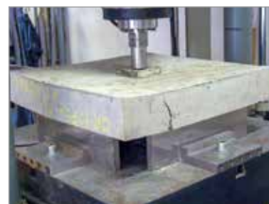
► Figuras 6 e 7 Corpos de prova para ensaios com fibras
