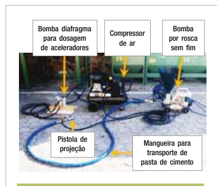
► Figura 1 Componentes do equipamento de projeção
