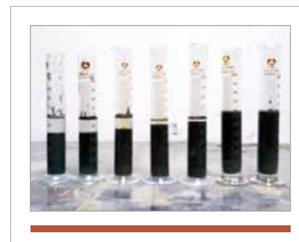
► Figura 8 Taxa de concretagem da calda de cimento aditivado com 0%, 0,6%, 0,8%, 1,0%, 1,2%, 1,4% e 1,6% de aditivo cristalizante após 24 h (Zheng, 2019)
