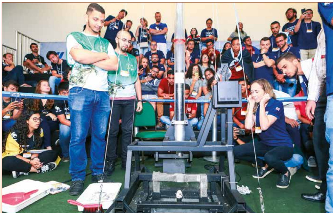
Ensaio de carregamento dinâmico do APO de uma das equipes inscritas
