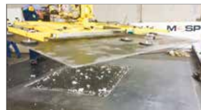
► Figura 6 Processo de içamento e retirada das placas das formas
