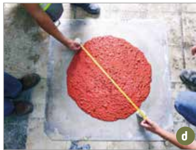
► Figura 9 Ensaio de espalhamento. Concreto sem pigmento (a e b); Concreto pigmentado vermelho (c e d) Fonte: autores
