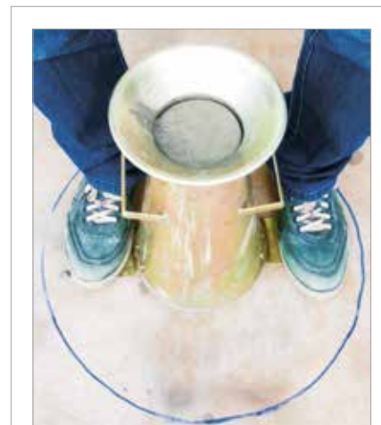
► Figura 1 Ensaio de slump flow test
