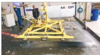
► Figura 6 Processo de içamento e retirada das placas das formas
