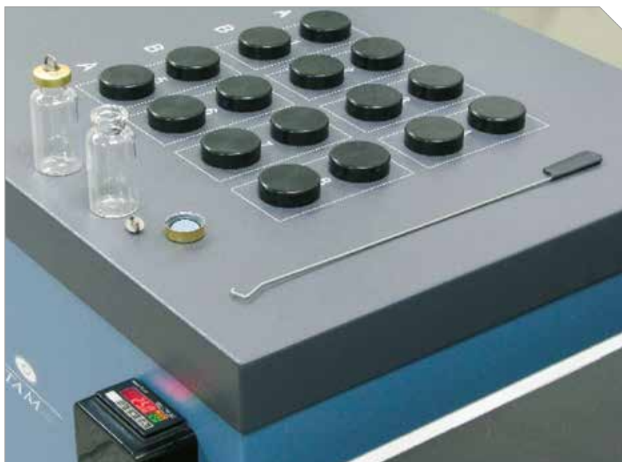
Calorímetro TAM Air para determinação da reatividade do cimento pela calorimetria isotérmica. Estão ilustradas as oito células para ensaio, onde são colocados os frascos contendo a pasta de cimento
