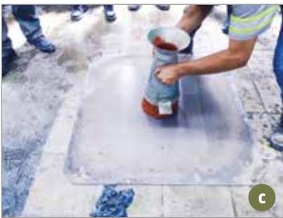
► Figura 9 Ensaio de espalhamento. Concreto sem pigmento (a e b); Concreto pigmentado vermelho (c e d) Fonte: autores
