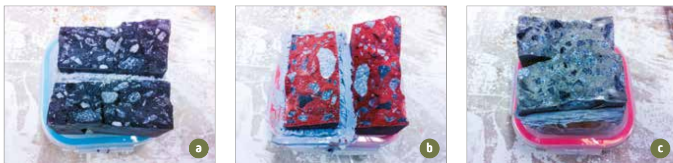
► Figura 12 Ruptura das amostras após o ensaio de lixiviação: concreto pigmentado preto (a); concreto pigmentado vermelho (b); concreto sem pigmento (c)
