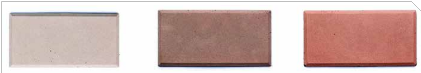
Ladrilhos produzidos com cimento Portland e lama vermelha num teor de substituição de 5%, 10% e 20%. Parte do projeto de reciclagem da lama vermelha no pós-doutorado do Dr. Roberto Cesar Romano – Laboratório de Microestrutura
