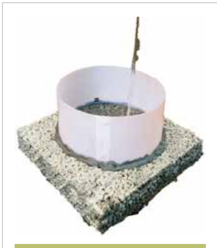
► Figura 6 Corpo de prova empregado na determinação do coeficiente de permeabilidade de permeabilidade Fonte: autores
