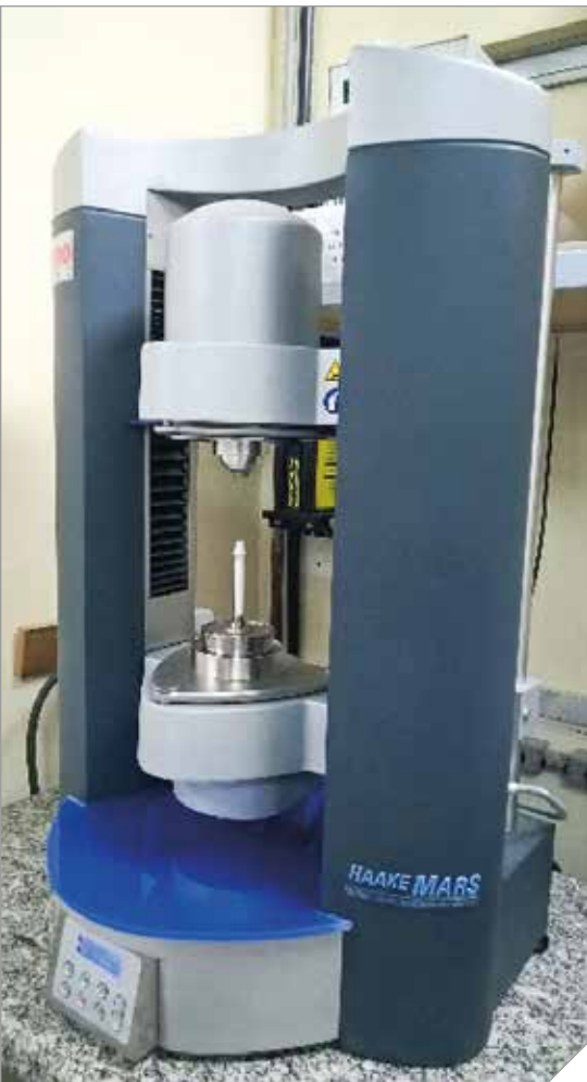
Reômetro MARS 60 – Os ensaios combinados de reometria e calorimetria permitiram avançar na análise do comportamento de pastas, nas primeiras horas de hidratação dos cimentos, período em que atuam os materiais cimentícios suplementares e os aditivos
