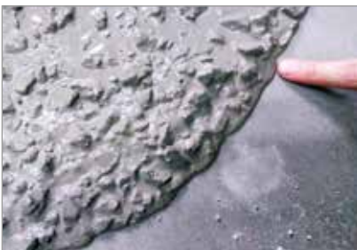
► Figura 10 Ausência de segregação da mistura. Concreto sem pigmento (esq.); Concreto pigmentado vermelho (dir.) Fonte: autores
