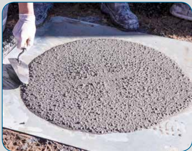
Verificação do espalhamento e do IEV no ensaio de abatimento
