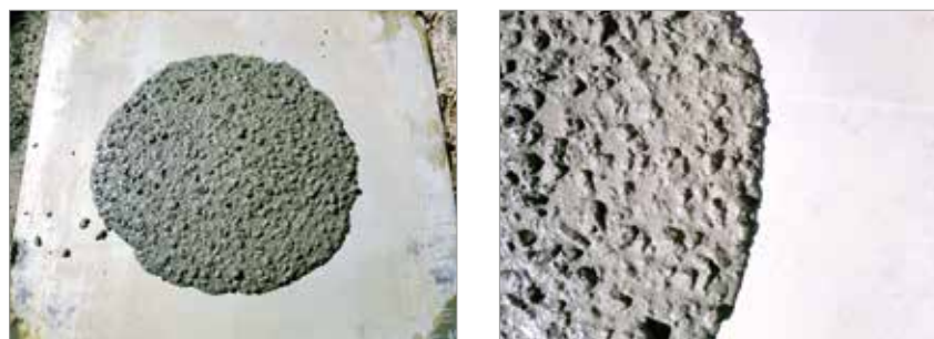
► Figura 1 Aspecto visual do concreto autoadensável observado durante o ensaio de espalhamento ( slumpflow test )
