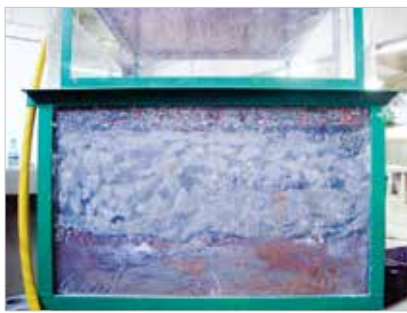
► Figura 16 Simulador da seção de um pavimento permeável
