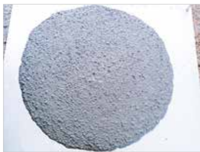
► Figura 7 Slump flow do CAA
