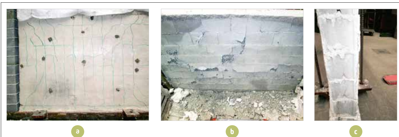
► Figura 10 Corpo de prova 2 – a) fissuração na face não exposta; b) destacamento na face exposta ao incêndio; c) fissuras verticais no meio do bloco e destacamento na face exposta (lado direito)
