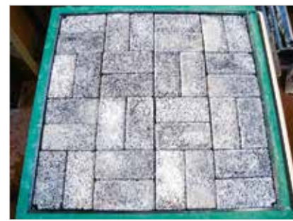
► Figura 16 Simulador da seção de um pavimento permeável
