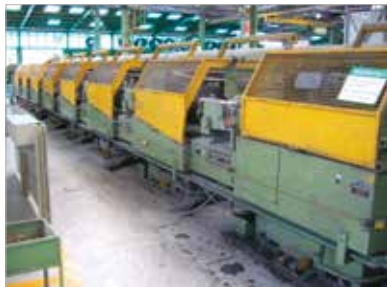
► Figura 1 Máquina de trefilar, onde a seção do aço é reduzida ao passar pelas feiras
