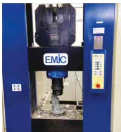
► Figura 2 Ensaio de resistência à compressão nos CPS de CAR
