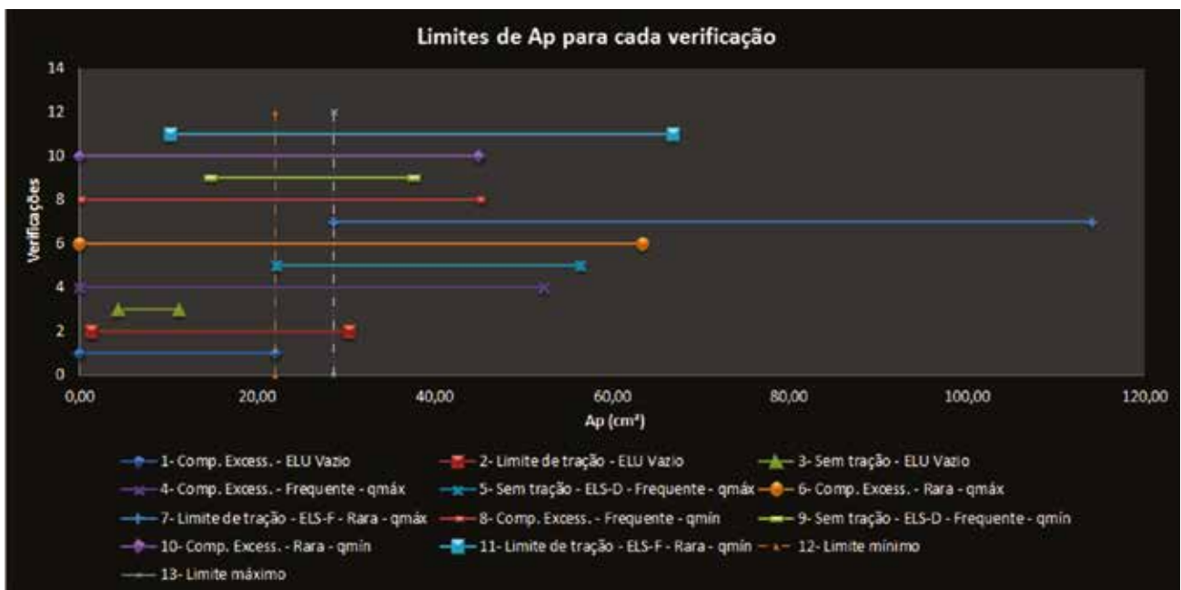
► Figura 13 Viga sem intervalo comum às verificações
