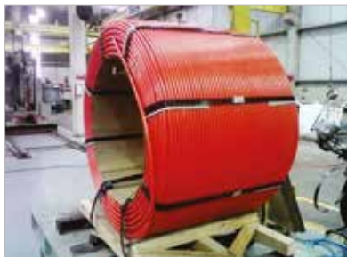
► Figura 7 Cordoalha CP 210 engraxada
