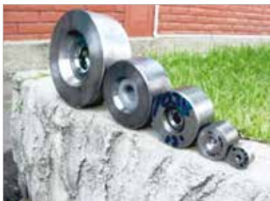
► Figura 2 Diversas feiras, por onde o fio máquina passa para ser reduzida sua seção
