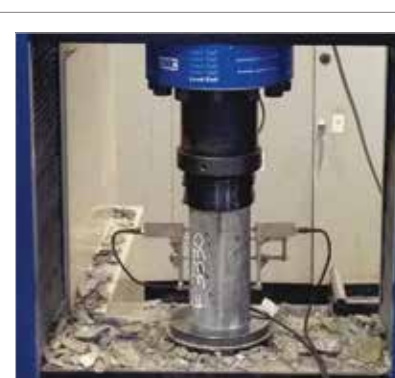
► Figura 4 Medição da deformação com extensômetro nos CPS de CAR
