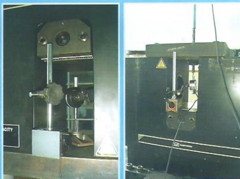
Figura 5. Sistema usado para medir a penetração da cordoalha nos dispositivos de ancoragem, usando transdutores de deslocamentos: a) esquema geral [cima], b) extremidades da cordoalha posicionadas junto às partes superior [esq.] e inferior [dir.] da máquina servo-hidráulica.
