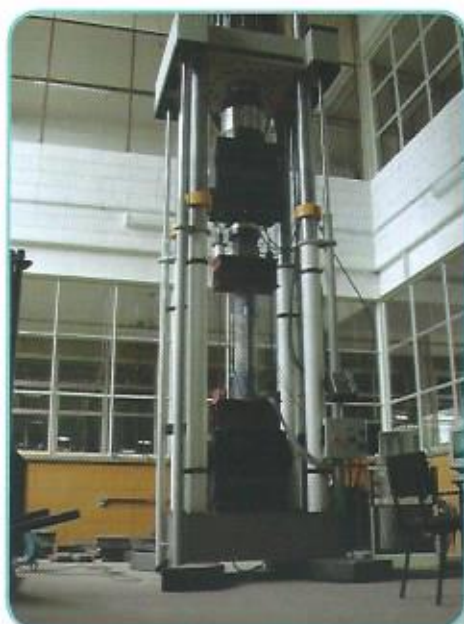
Ensaio de pilar reforçado sob pré-carregamento, na Máquina Universal de Ensaio INSTRON, servo-hidráulica com capacidade de 300 toneladas-força e altura máxima do corpo-de-prova igual a 4 metros, no Laboratório de Estruturas da EESC-USP
