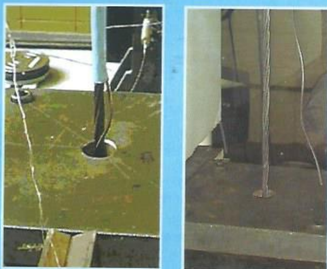
Figura 10. Diferença de comportamento observado nos ensaios, referente à utilização do plástico (azul) na região central da cordoalha.
