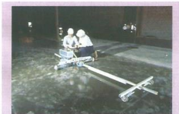
Figura 6. Perfilógrafo para evaluar tolerancia de F_{min} en sectores de tráfico definido (Holland, 1991)
