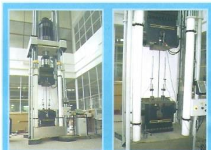
Figura 4. Máquina servo-hidráulica [esq.] e dispositivos do tipo LVDT [dir.]
