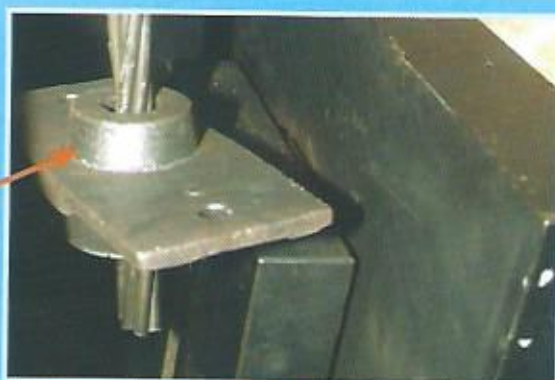
Ruptura de um dos fios da cordoalha na ligação com o dispositivo de ancoragem
