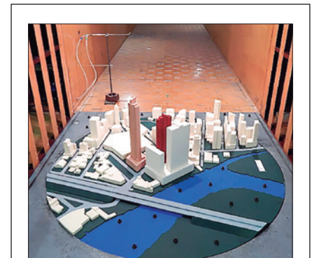
▶ Figura 7 Ensaio de túnel de vento com efeito Venturi. Fonte: BRE (Inglaterra)
