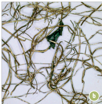
► Figura 1 Amostra da fibra de aço reciclada: (a) máquina fotográfica comum e (b) microscópio digital (marca Zeiss, modelo Smartzoom 5)
