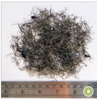
► Figura 1 Amostra da fibra de aço reciclada: (a) máquina fotográfica comum e (b) microscópio digital (marca Zeiss, modelo Smartzoom 5)
