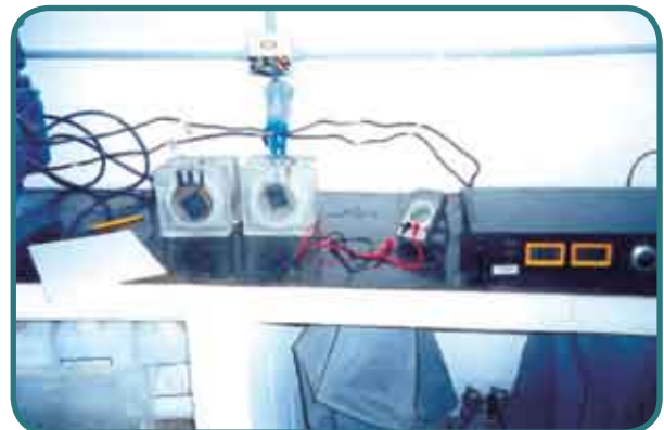
Fig 14 – Detalhe do ensaio de determinação da resistência à penetração de cloretos
