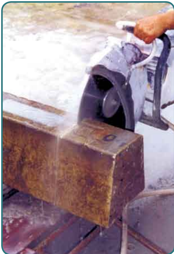
Figura 02 – Detalhe do corte dos dormentes
