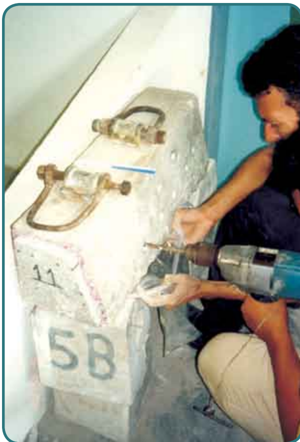
Fig 13 – Operação de furação e coleta das amostras para determinação do perfil de cloretos
