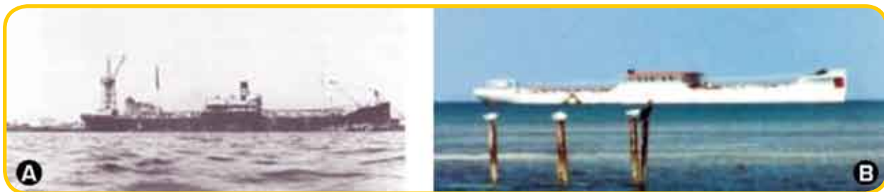
Figura 14 – Navios de concreto construídos na primeira guerra mundial: (a) navio SS Cuyamaca em San Diego, Julho 1920; (b) Navio SS San Pasqual, hoje um hotel em Cuba ( www.concreteships.org )
