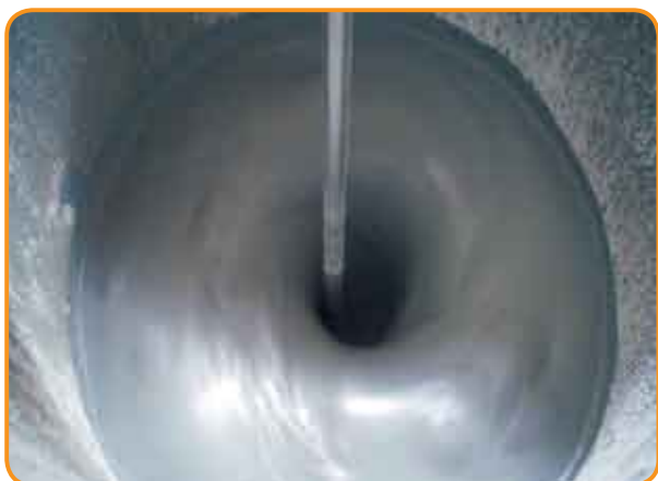
Exemplo de pré-dispersão de sílica ativa em fase aquosa com aplicação de alto cisalhamento
