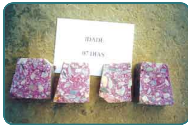
Fig. 11 – Superfície cortada de 04 amostras de 04 dormentes distintos na cor vermelho carmim, que foram expostas a carbonatação acelerada
