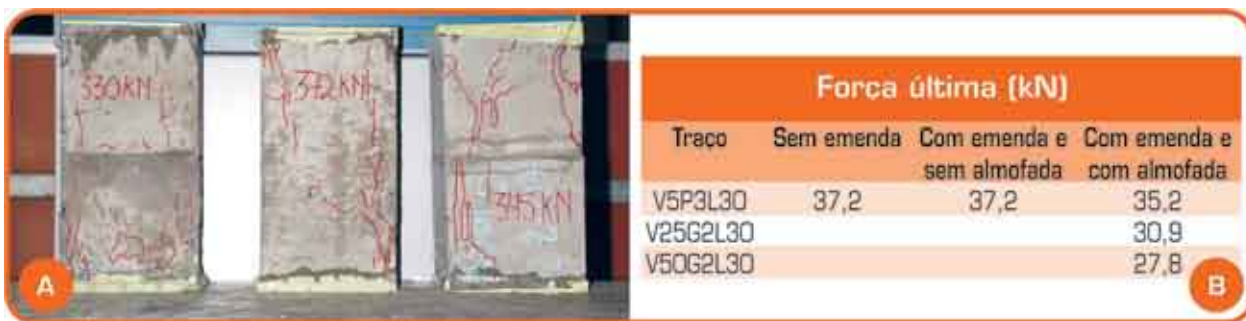
Fig. 6 – Estudo de almofada de CCRF: a) ensaio de blocos de concreto e b) resultados dos ensaios para algumas misturas [EL DEBS & MONTEODOR (2005)]
