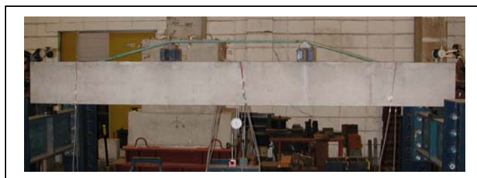
Figura 1 - Forma de aplicação do carregamento e instrumentação realizada.
