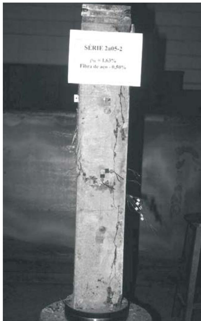
fornece resultados experimentais acima dos teóricos. Isto significa claramente que para valores do cobrimento de armadura da ordem de 2cm, esta parte da seção transversal não contribui para a seção resistente do pilar.
