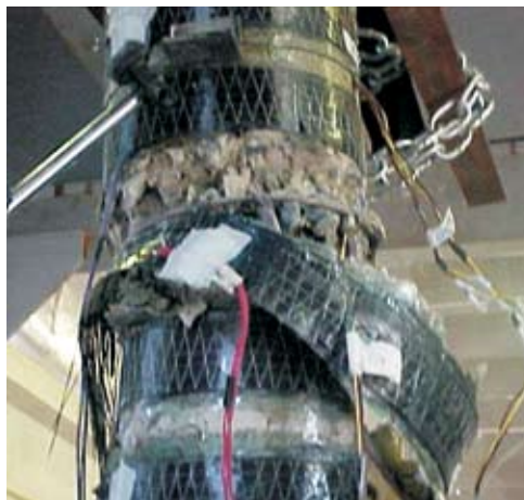
Figura 8 - Ruptura laço PRFC - PC02S'5
