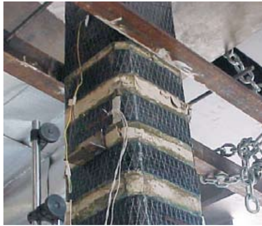
Figura 7 - Ruptura do concreto entre os laços
