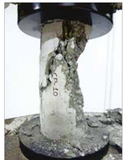
d Concreto C-60 FeNi após o ensaio
