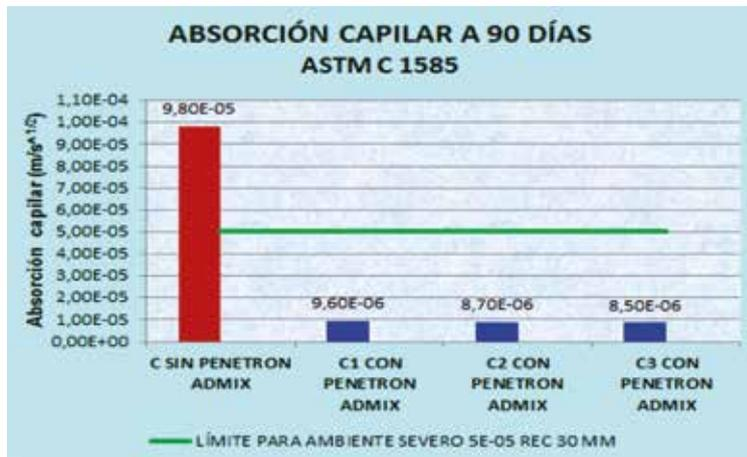
**Notas:** O limite especificado corresponde aos critérios de avaliação estabelecidos no *Manual Durar Cyted*. Esta publicação indica que, com uma espessura do cobrimento de 30 mm, a absorção capilar limite em ambientes severos é  $\leq 5E-05$  (m/s<sup>1/2</sup>) e, em ambientes menos severos, 10E-04 (m/s<sup>1/2</sup>).
