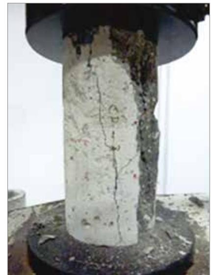
b Concreto C-40 FeNi após o ensaio
