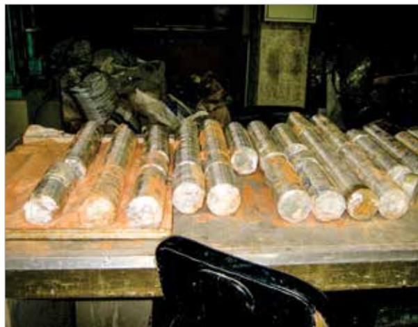
Figura 3 – Extração de testemunhos de concreto (Fonte: PhD Engenharia)
