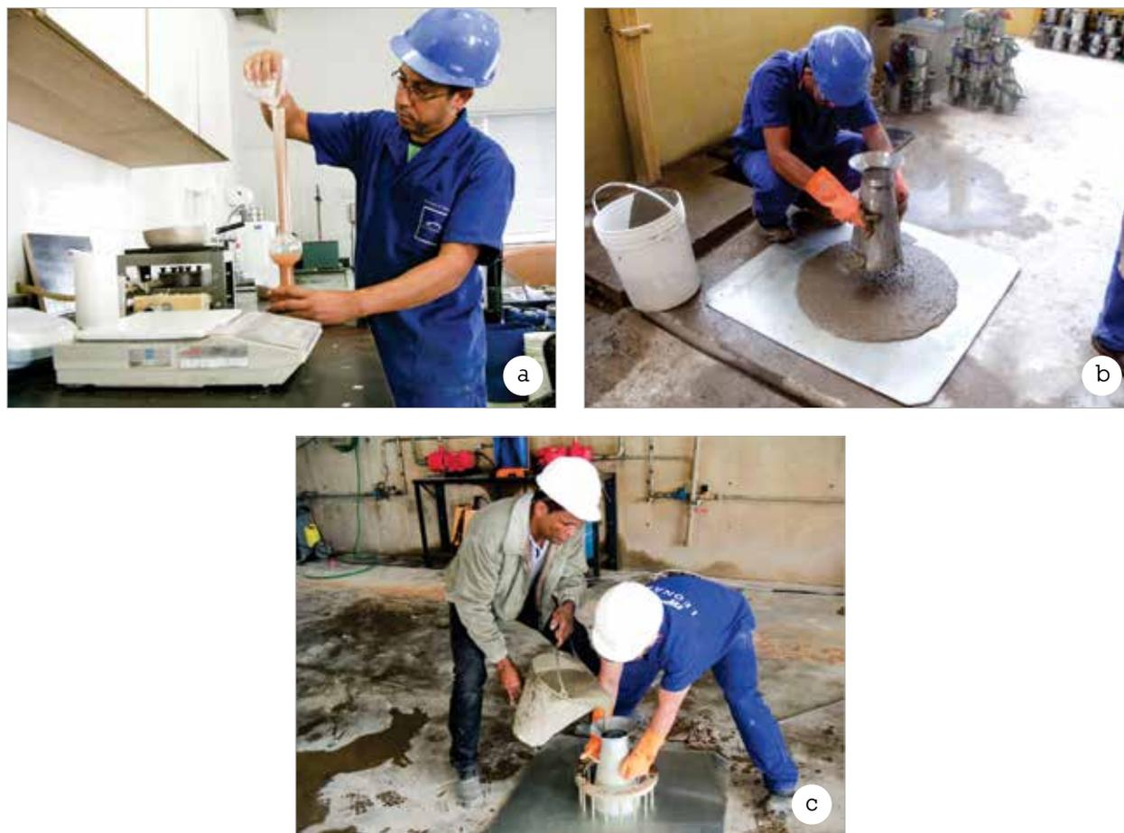
Figura 3 – Controle de qualidade. (A) Determinação da umidade do agregado miúdo, (B) Ensaio de espalhamento (*slump-flow*) e (C) Ensaio de anel J (*J-ring*)
