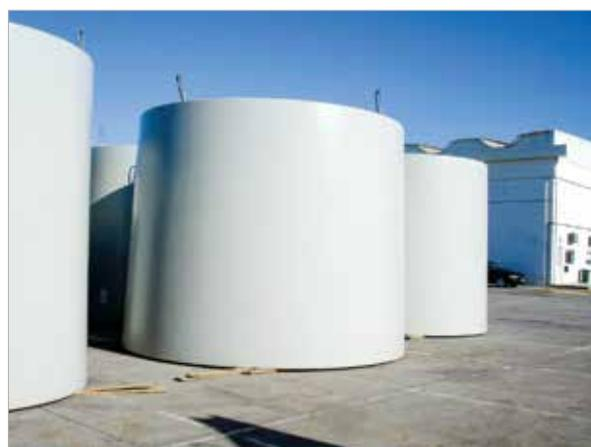
Figura 18 – Anéis pré-moldados com juntas horizontais (fonte: Enercon)
