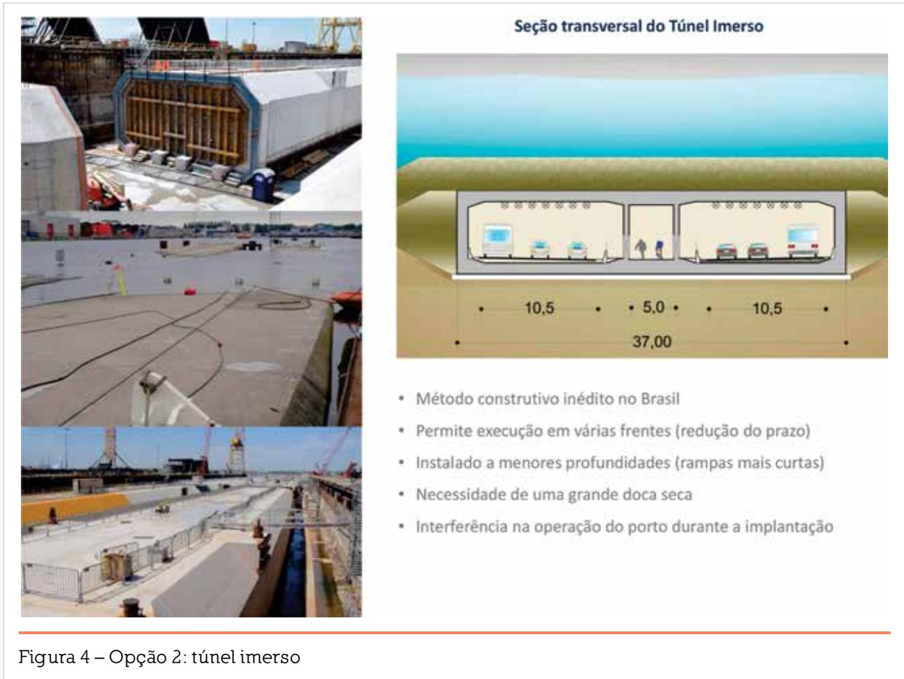
Figura 4 – Opção 2: túnel imerso
