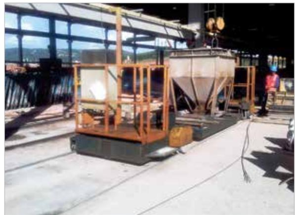
Figura 6 – Transporte do concreto autoadensável com carrinho sobre trilhos
