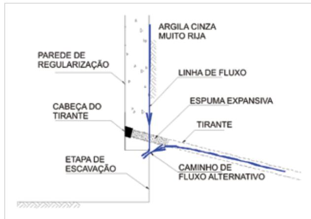
Figura 15 – Fluxo de água atrás da vedação da cabeça do tirante
