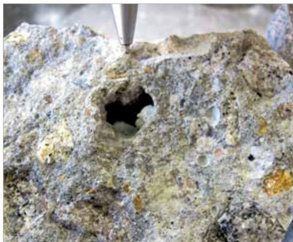
Figura 6 – Deposições no interior de um poro (Concreto 01)
