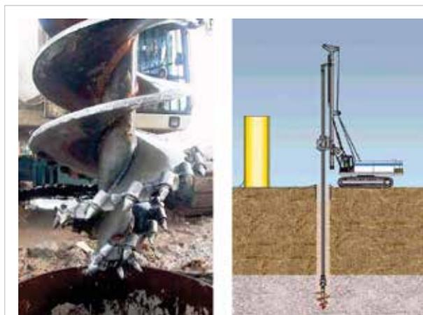
Figura 4 – Escavação com trado com bits
