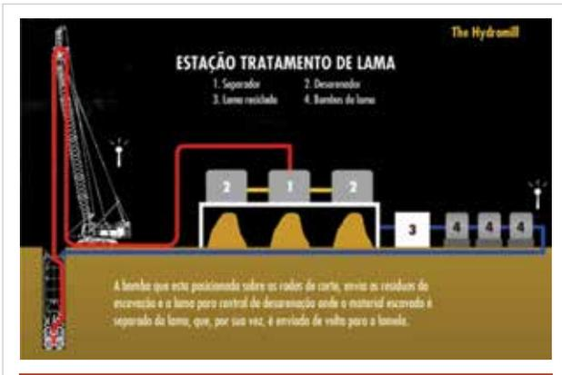
Figura 16 – Esquemático da circulação da lama
