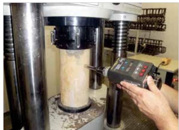
Figura 7 – Execução do ensaio de esclerometria (Local: ÍME)
