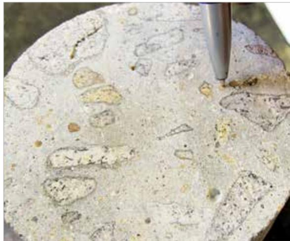
Figura 9 – Superfície do testemunho indicando vários agregados com bordas (Concreto 02)
