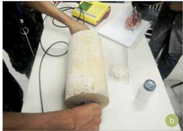
Figura 6 – a) Detalhe do equipamento de ultrassom. b) Execução do ensaio de ultrassom. (Local: ÍME)
