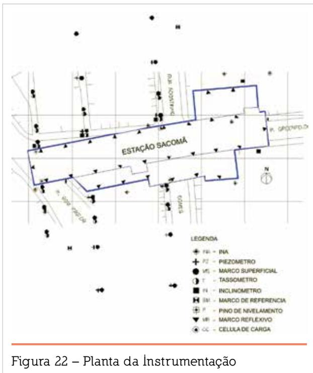
Figura 22 – Planta da Instrumentação
