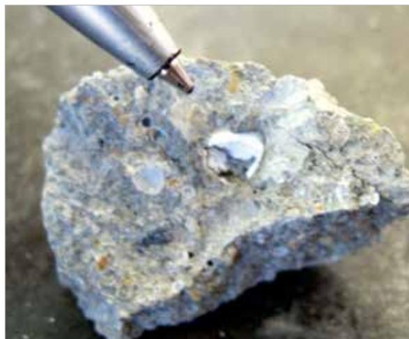
Figura 8 – Material branco preenchendo parcialmente um poro e revestindo outro poro (Concreto 02)
