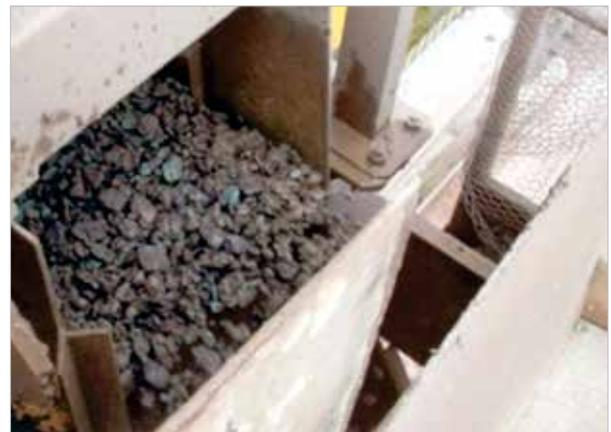
Figuras 9 e 10 – Material rochoso separado do fluido pela primeira fase do processo de limpeza
