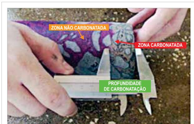
Figura 7 – Identificação da zona de carbonatação por meio de um indicador de pH
