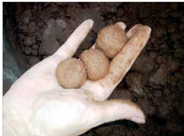
Figura 3 – Formação de “pelotas” na preparação da argamassa
