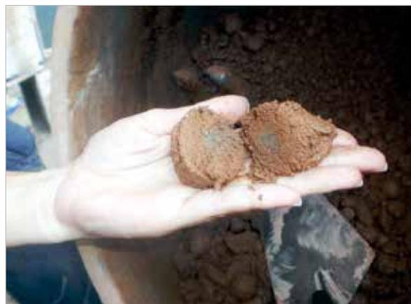
Figura 4 – Detalhe das “pelotas” formadas, contendo cimento e areia em seu interior
