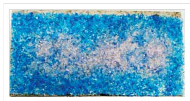
Figura 4 – Teste indicativo de umidade interna (área rosa), mesmo após 12 dias de secagem em estufa a  $105^\circ\text{C}$
