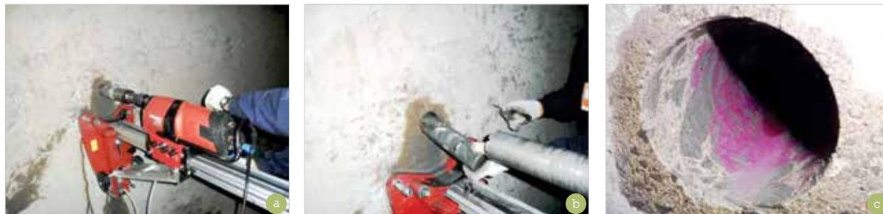
Figura 6 – extração das amostras a) perfuração; b) retirada do testemunho; c) local da extração
