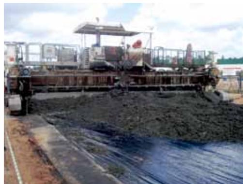
Vibroacabadora Wirtgen SP 1200
