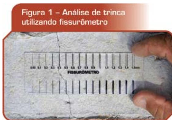
Figura 1 – Análise de trinca utilizando fissurômetro
