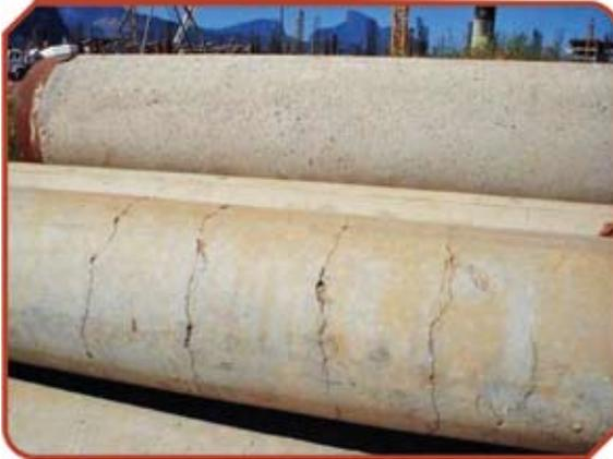
podem aparecer em um ou outro ponto ao longo do fuste. No caso de ocorrência de inúmeras trincas, principalmente em um determinado trecho do fuste, a estaca deve ser recusada. A Figura 6 ilustra uma estaca com inúmeras trincas em um pequeno trecho do fuste, a qual certamente deve ser inutilizada.
