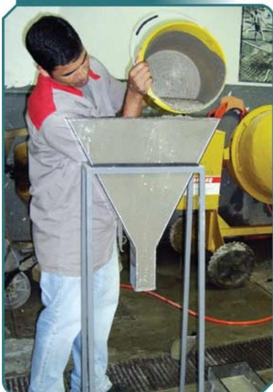
A Norma Brasileira prevê a realização do ensaio com o cone na posição normal, seguindo uma tendência internacional (ASTM 1611 e EN 12350-8). Ensaios reali-
