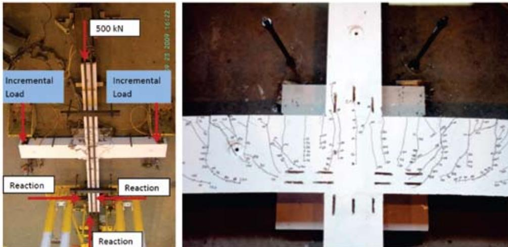
Figura 4 – Critérios de desempenho para ligações viga-pilar com resistência à flexão em estruturas pré-moldadas: 1) ligações com resistência à flexão com comportamento semi-rígido; 2) ligações com resistência parcial à flexão (redistribuição plástica); 3) ligações com alta resistência e alta rigidez. [Ferreira (2010)]
