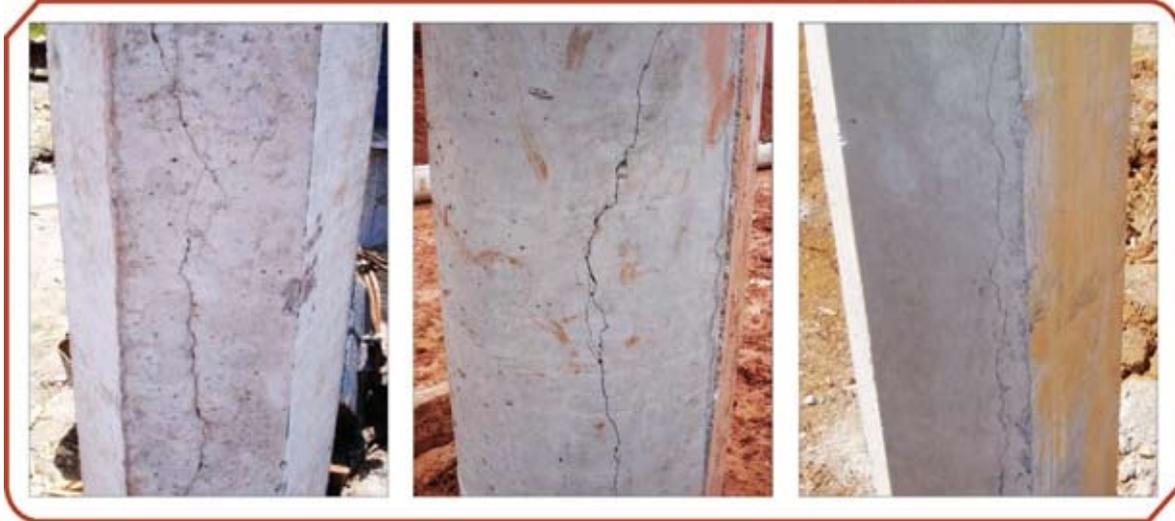
ao eixo longitudinal das estacas. Neste caso, as estacas deverão ser sempre rejeitadas (Figura 3), pois, na maioria das vezes, não suportam a cravação a que serão submetidas.
