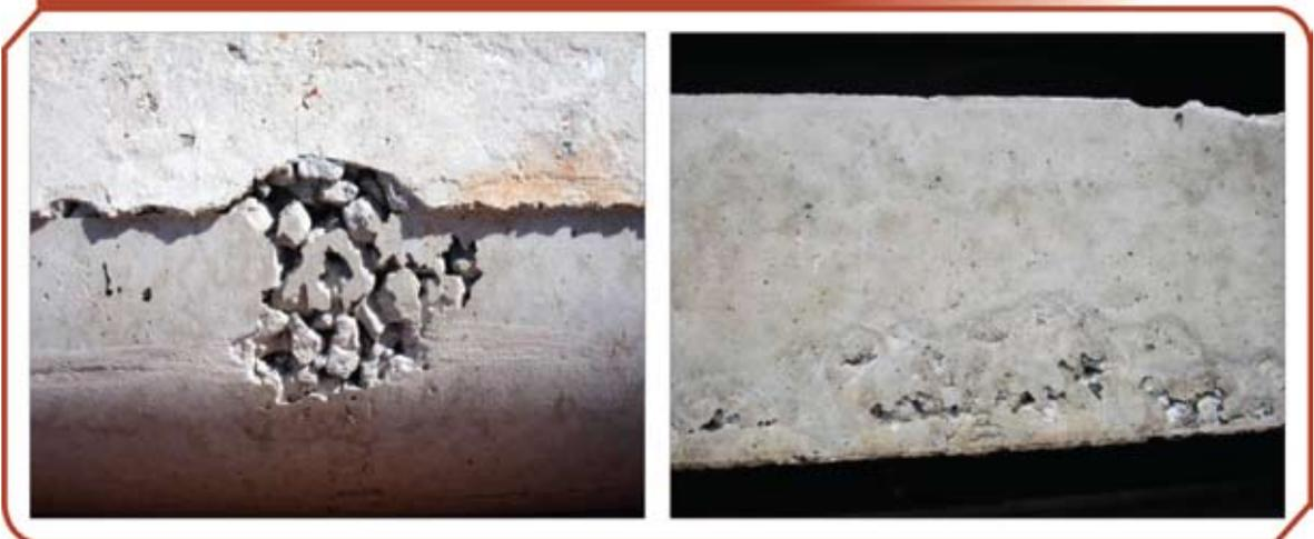
Figura 9 – Esmagamento da cabeça de estacas durante o processo de cravação
