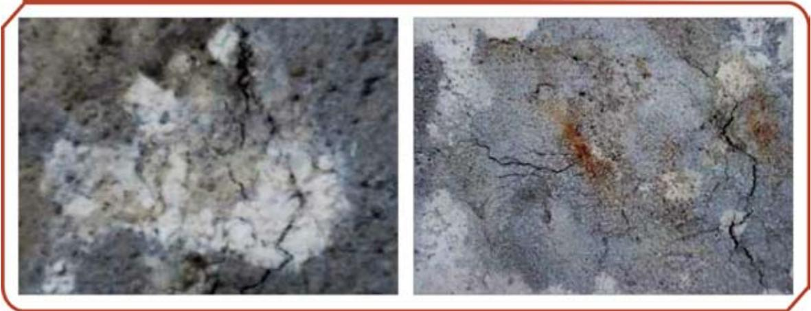
tificar a rejeição de estacas, porém recursos técnicos devem ser adotados para que sejam evitadas. Raramente ultrapassam alguns centímetros de comprimento e 2 a 3 milímetros de profundidade, apresentando-se sempre de forma desordenada na superfície das estacas. A Figura 11 ilustra esse tipo de problema.
