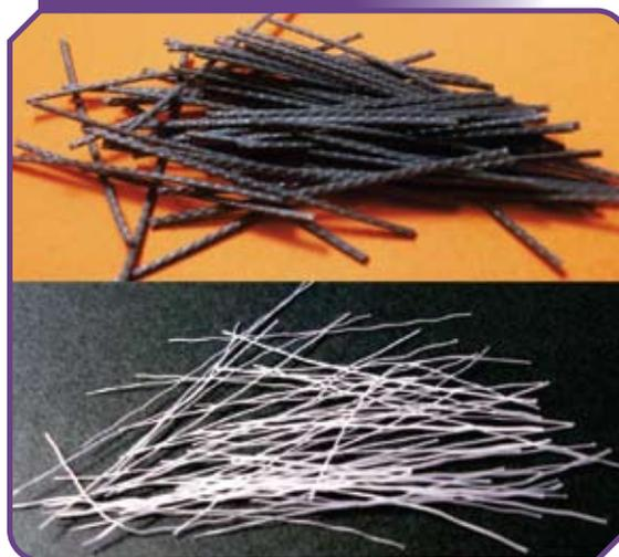
creto com fibras de aço, o que pode prejudicar a fluidez do material. Assim, não é possível realizar a mera substituição de uma fibra pela outra, mas deve-se, sim, realizar estudos de dosagem específicos.
