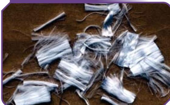
Foto 2 – Cilindro de macrofibras poliméricas produzido para lançamento direto na betoneira, para mistura no concreto
