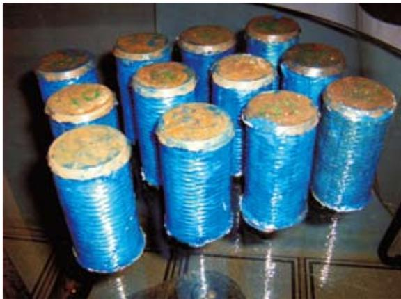
concreto. Ele é conseguido pela orientação das fibras transversalmente ao eixo longitudinal do elemento. As fibras confinantes se comportam similarmente a estribos em espiral ou mesmo a estribos convencionais. Nenhuma contribuição de fibras alinhadas longitudinalmente deve ser considerada para efeito de confinamento.
