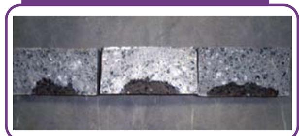
Foto 4 – Corpos-de-prova com 1% de adição com uma semana de indução
