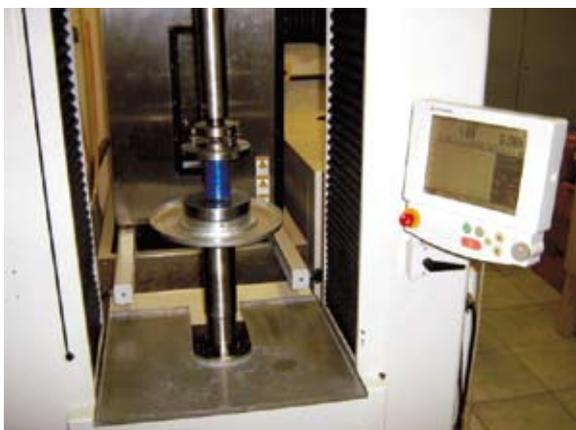
Figura 2 – Vista do ensaio de sondagem acústica em corpo-de-prova
