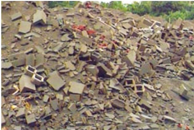
Resíduos de blocos de concreto produzidos em uma fábrica de pré-moldados
