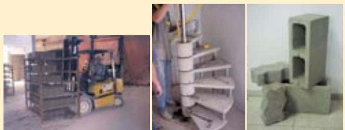
Figura 03: Pré-fabricação de materiais com uso das cinzas pesadas (blocos estruturais e escada).
