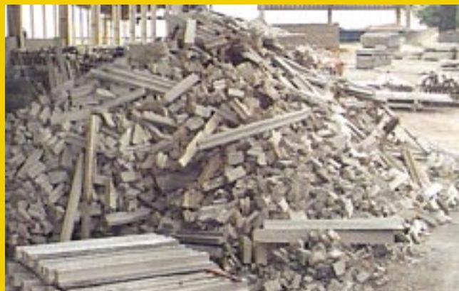
Resíduos de vigotas de concreto produzidos em uma fábrica de pré-moldados
