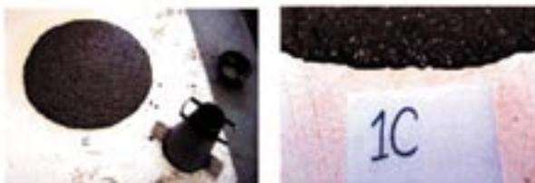
Figura 12: C. A. A. fluido sem segregação
