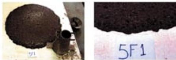
Figura 11: C. A. A. com tendência à segregação
