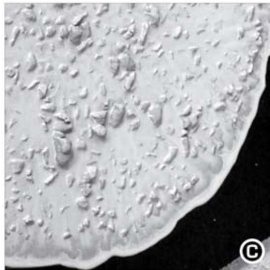
C – Leve exsudação de água, observada na beirada do concreto
