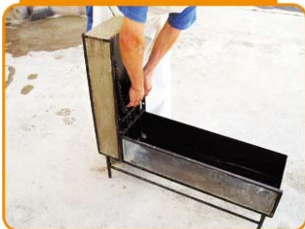
congestionadas de armaduras, sem segregar, perder uniformidade ou causar bloqueio, verifica-se a relação entre as alturas H2 e H1 (situadas na extremidade posterior e anterior às armaduras, respectivamente), depois de realizada a intercomunicação do CAA entre as partes do equipamento. O resultado deve estar entre 0,8
